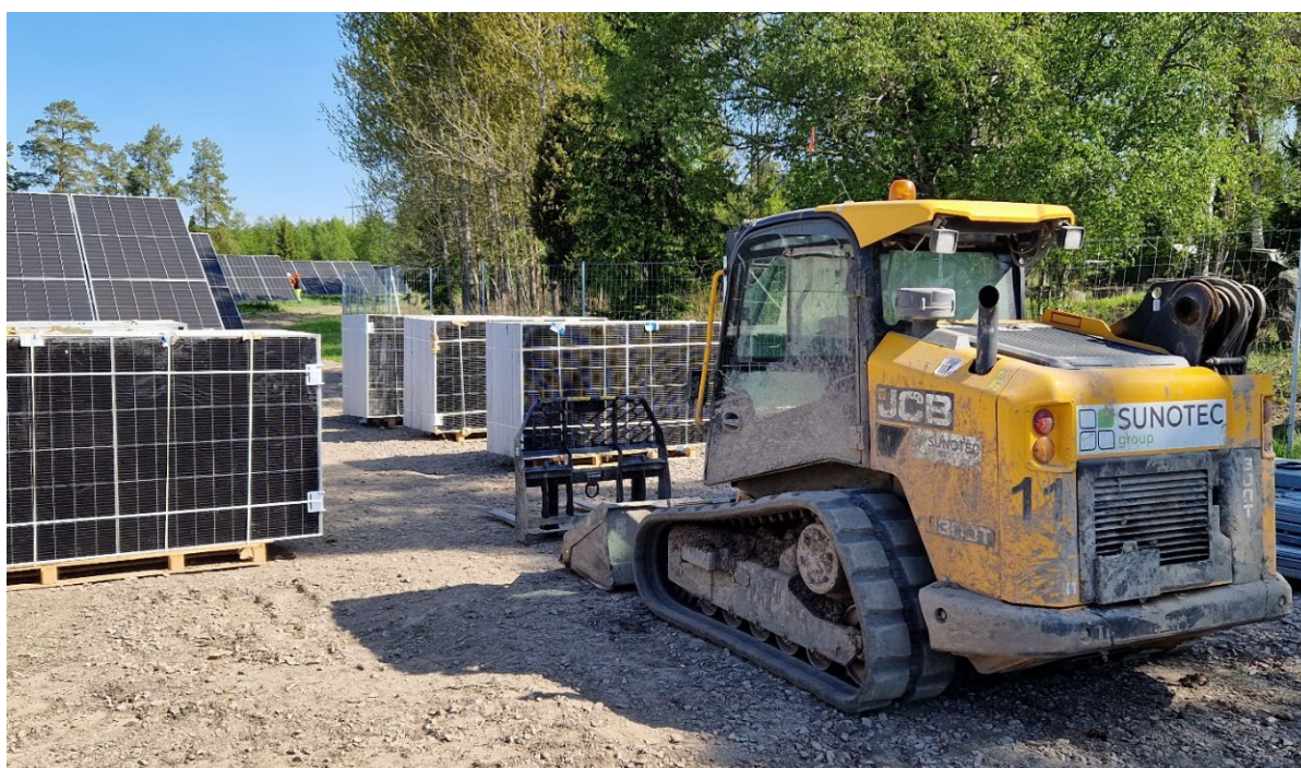
Figur 10. Exempel på mindre bandgående fordon som används för utkörning av solceller och material. Marktrycket är lågt.
