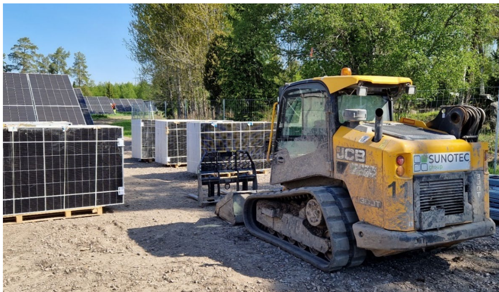
Figur 25. Exempel på mindre bandgående fordon som används för utkörning av solceller och material. Marktrycket är lågt.
