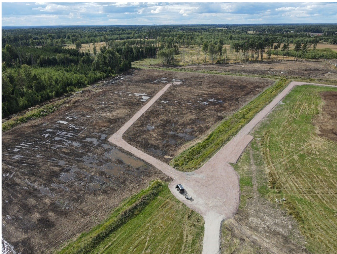
Figur 35-Solcellspark under konstruktion. Till höger i bild har marken brukats som jordbruksmark och till vänster som skogsmark. Byggvägar fram till transformator har här anlagts.
