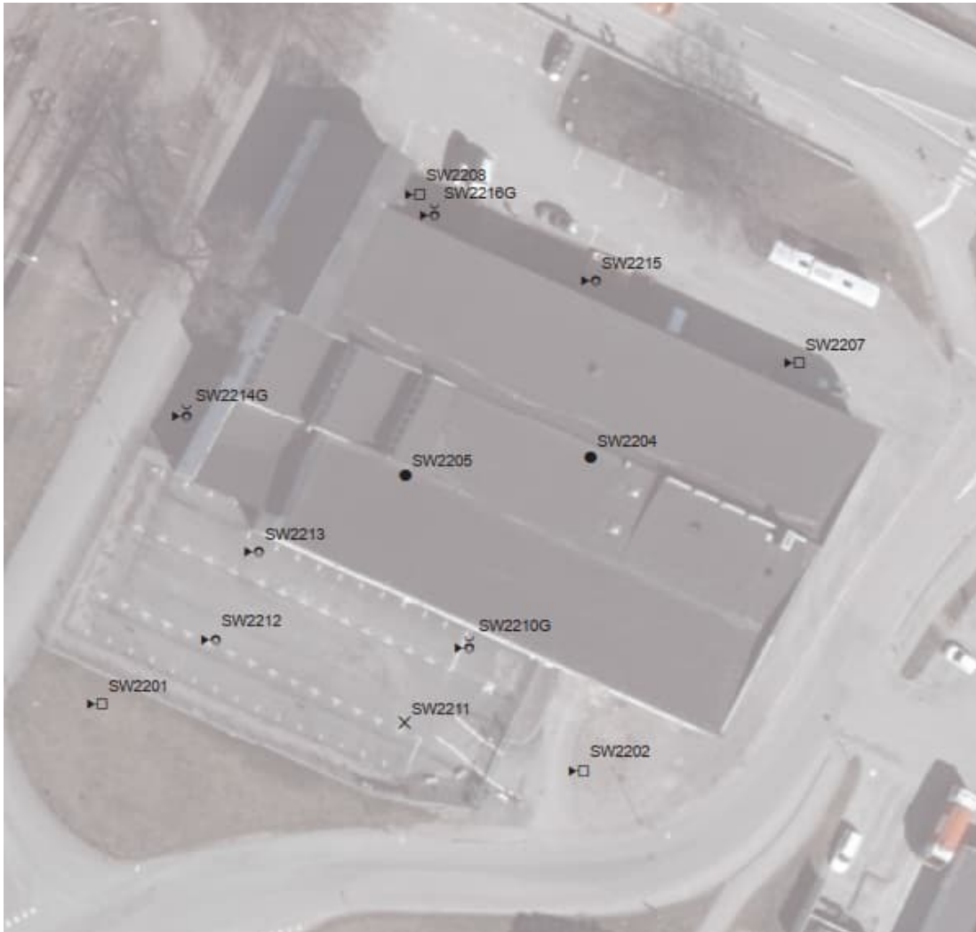
Figur 6. Provtagningspunkter på Viadukten 5. Urklipp från Rapport miljöteknisk markundersökning, kv Viadukten 5, Alvesta. Sweco, 2022-04-01.
