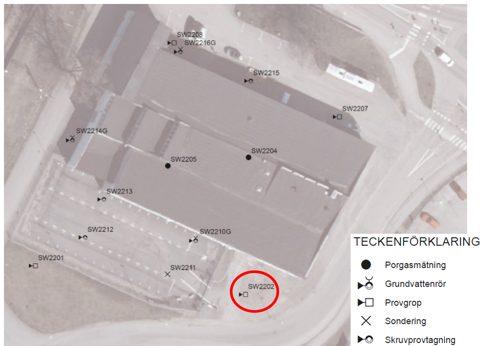
Provpunkter miljöteknisk markundersökning 2022. Punkt där värden överskrider MKM markerad med röd ring.
