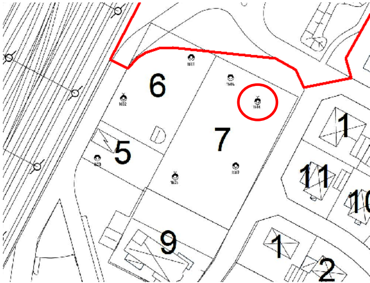
Provpunkter miljöteknisk markundersökning 2017. Punkt där värden överskrider MKM markerad med röd ring.
